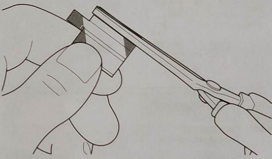
★エッチングパーツ①はエッチングベンダーなどを使って下図のように折り曲げバケットに組み込みます。
